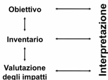
Figura 1.1 - La struttura della LCA proposta dalla ISO 14040.
